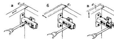
Схема регулировки дверей после навески на корпус:
