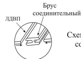
Схема крепления бруса соединительного
